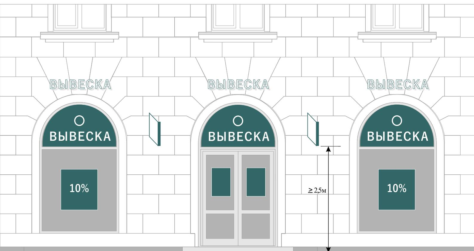
Примеры нормативного размещения вывесок и информационных табличек, мемориальных досок. По оси элемента фасада (окна, двери, витрины). Не более 10% светопрозрачной конструкции. На фриззах
